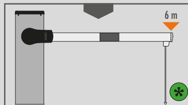
asta con giunto interno (opzione con appoggio mobile)
